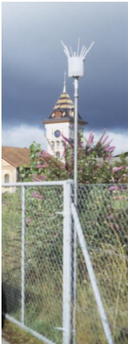
schlossen. Das gesammelte Staub-Regenwassergemisch wird im Labor eingedampft und der Schwermetallgehalt des Rückstands gemessen. Organische Schadstoffe hingegen werden direkt aus dem Staub-Regenwassergemisch mit Lösungsmitteln extrahiert. Aus der daraus bestimmten Masse wird die pro m<sup>2</sup> und pro Tag deponierte Menge berechnet.
